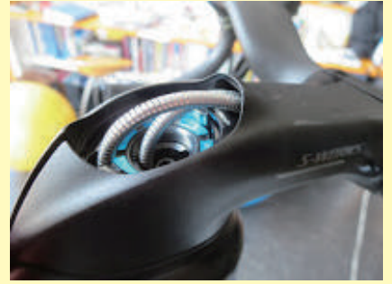
S-Works Venge Vias の悪夢のような内装作業
